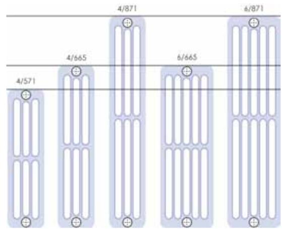
Il calorifero in ghisa NeoClassic è realizzato con le più moderne tecnologie fusorie e meccaniche tali da garantire una durata nel tempo superiore a qualsiasi altro tipo di calorifero. Ogni elemento è lavorato individualmente e testato ad una pressione di 10,5 bar sia prima che dopo la lavorazione meccanica, al fine di assicurare affidabilità totale alla pressione di esercizio fino a 7 bar. A garanzia del cliente, su ogni elemento è impresso il contrassegno CE ed il marchio Ideal Clima.
